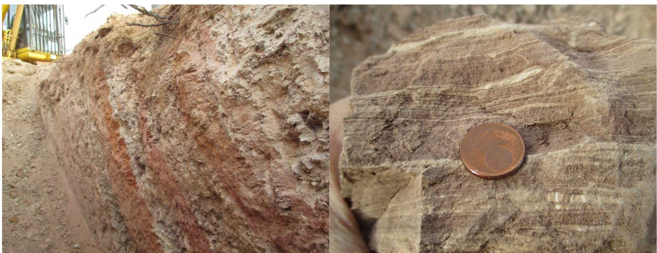
Figura 4 - Aspectos da unidade gresosa Ct – Cretácico médio. Em poço aberto sobre a zona central do túnel e à direita aspecto microbandado de arenito de grão fino em amostra de mão
